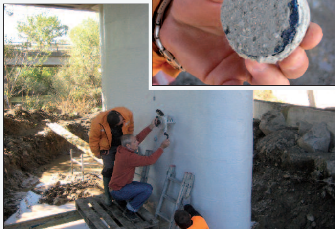
Figure 7A e 7B - Tipiche rotture per prove di pull-out
